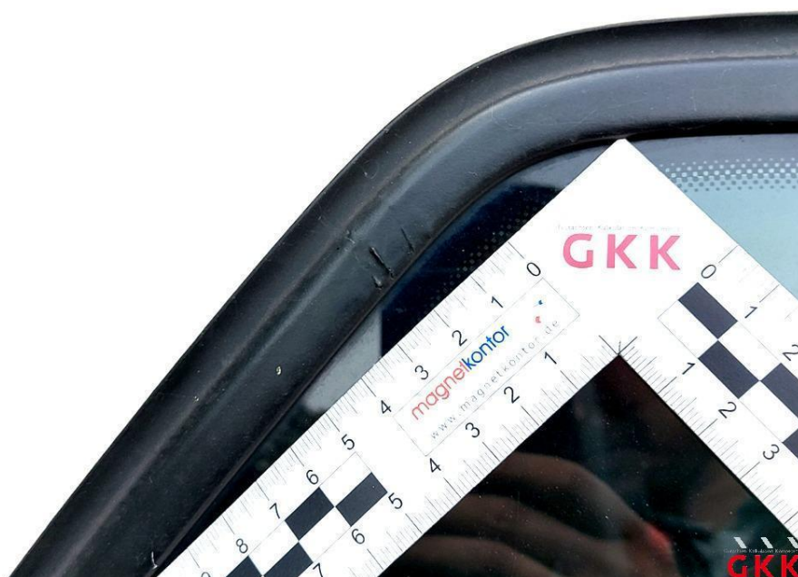
Bild 28 Seitenwand rechts, Scheibe -Rahmen-, beschädigt, ersetzen
