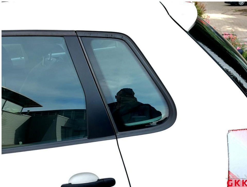
Bild 17 Seitenwand links, Scheibe -Rahmen-, beschädigt, ersetzen
