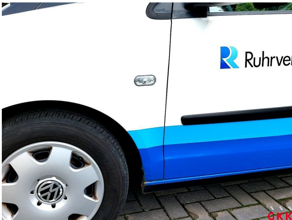
Bild 19 Kotflügel vorne links, korrodiert, lackieren
