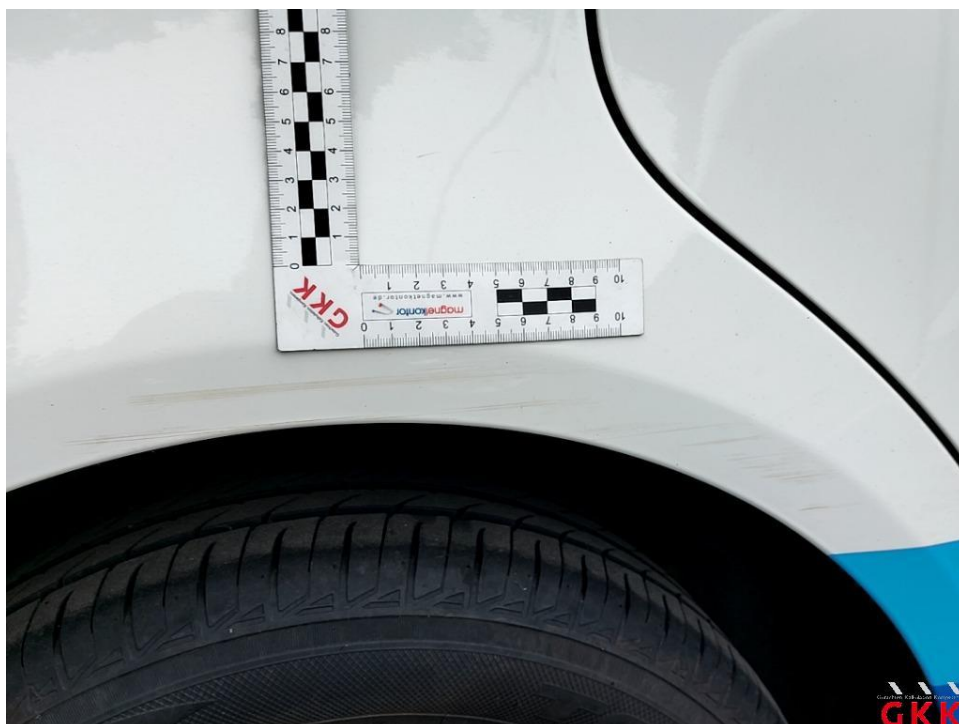
Bild 26 Seitenwand rechts, verkratzt, Smartrepair
