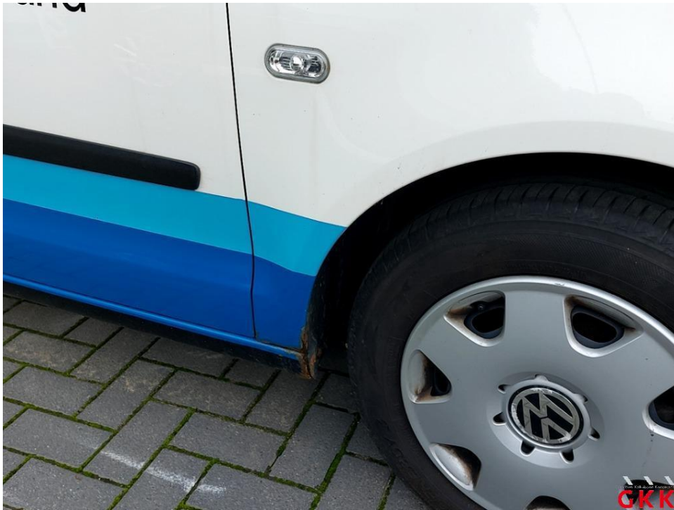
Bild 21 Kotflügel vorne rechts, korrodiert, lackieren
