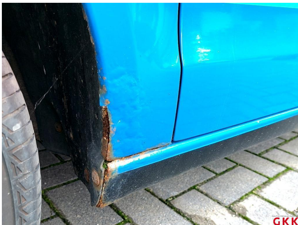
Bild 20 Kotflügel vorne links, korrodiert, lackieren
