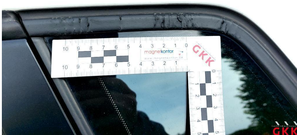
Bild 18 Seitenwand links, Scheibe -Rahmen-, beschädigt, ersetzen
