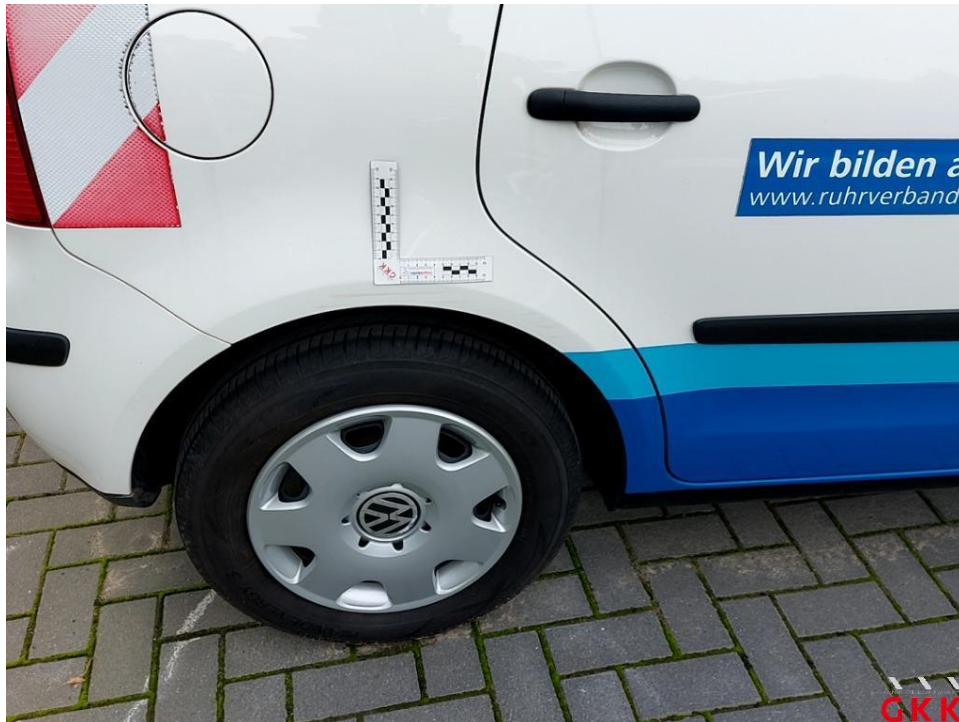
Bild 25 Seitenwand rechts, verkratzt, Smartrepair
