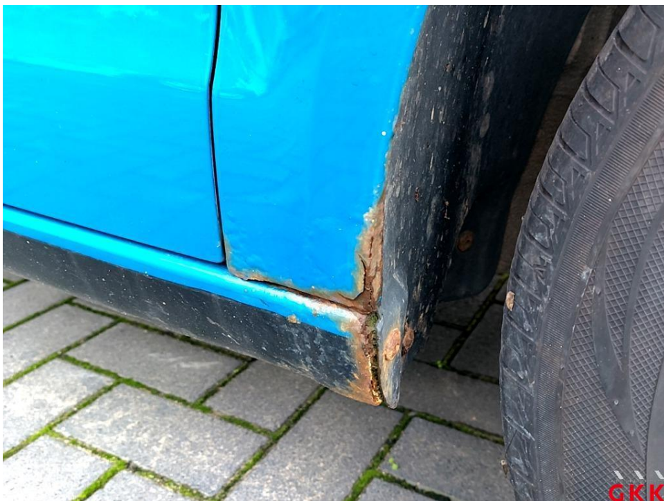
Bild 22 Kotflügel vorne rechts, korrodiert, lackieren
