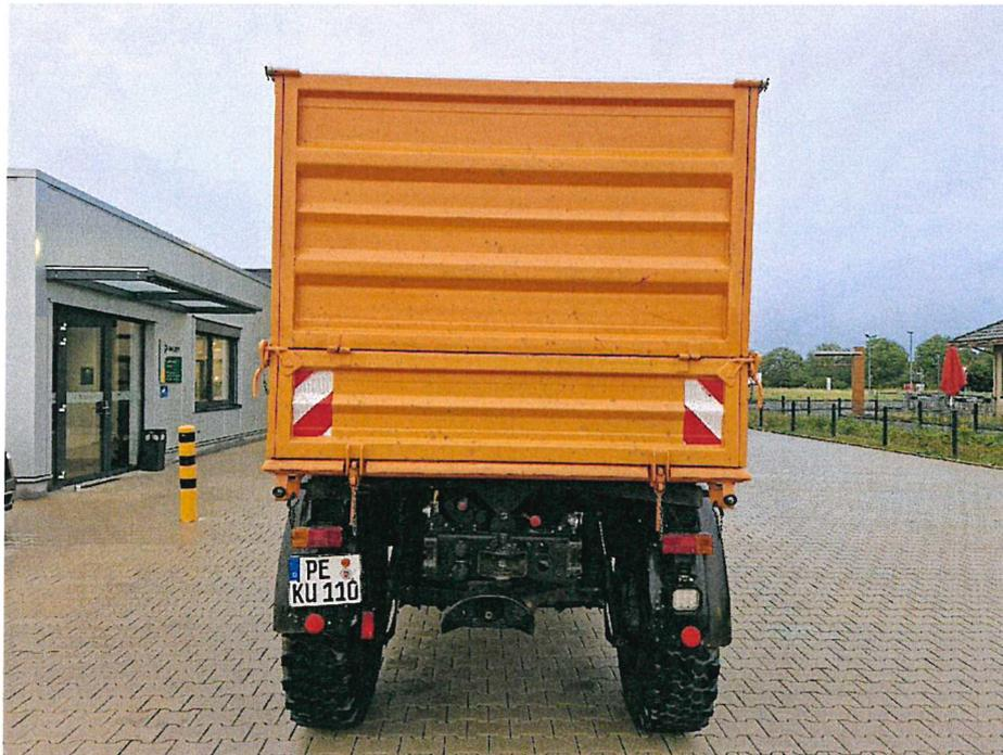
Bild 11 : Heck m. Hydraulik, Zapfwelle, Bolzenkupplung, Zweileitungsbremse
