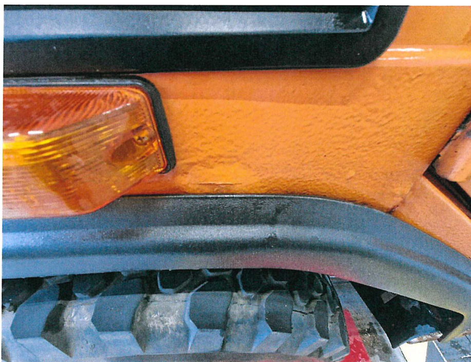
Bild 19 : Kotflügel links korrodiert
