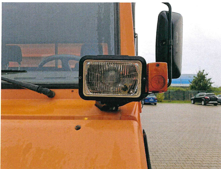
Bild 20 : Zusatzscheinwerfer links Reflektor matt
