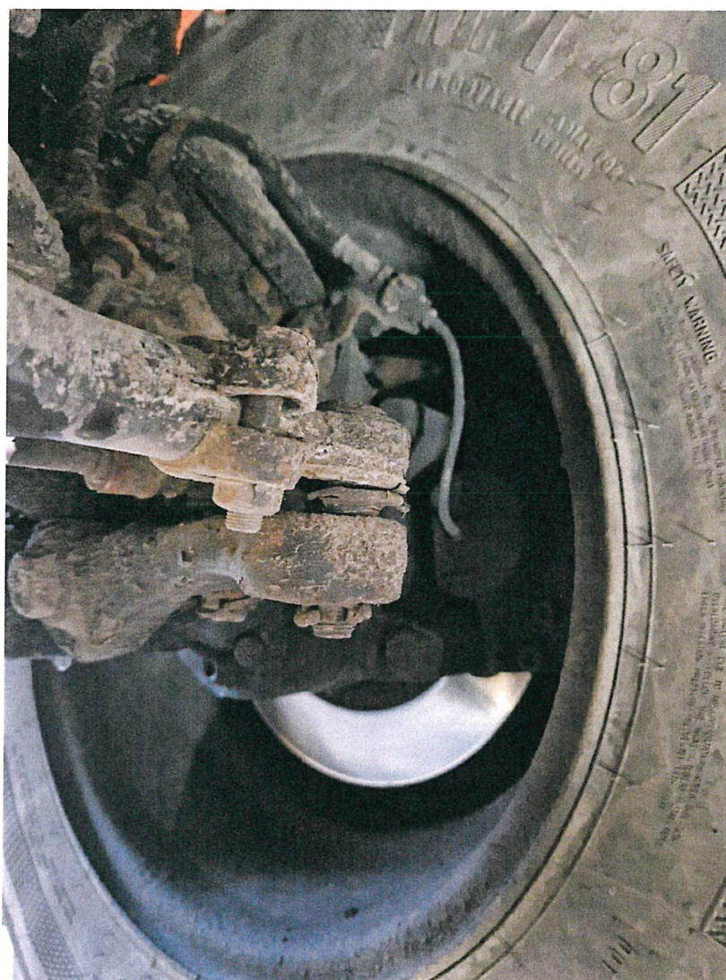
Bild 17 : Spurstangenkopf rechts verschlissen
