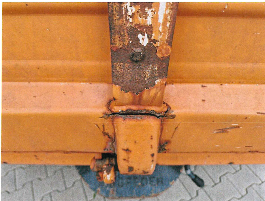
Bild 12 : Bordwände tw. eingerissen
