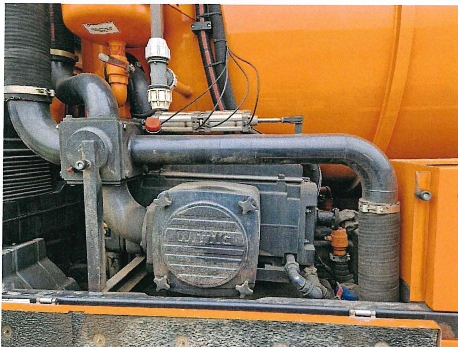
Bild 11 : dokumentiert Vakuumpumpe
